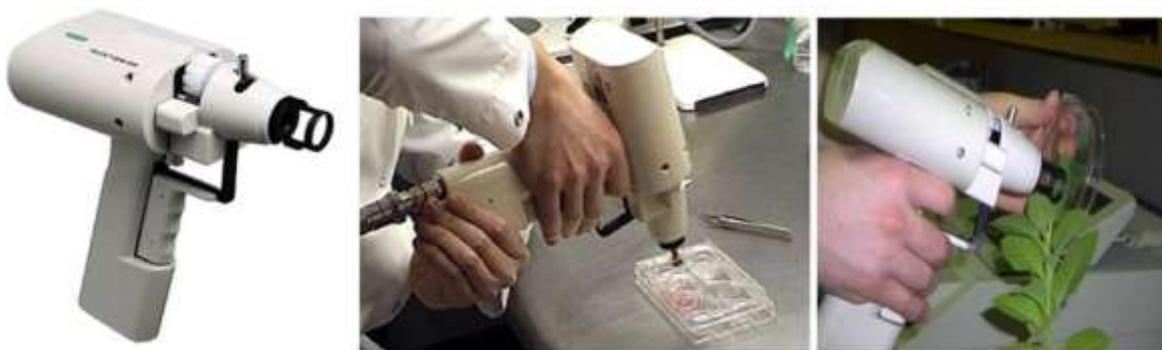
**Figura 6** – Sistema de transfecção transiente Helios Gene Gun BioRad™ para transformação de tecidos e culturas celulares (imagem obtida de <http://physics.ucsd.edu>).
